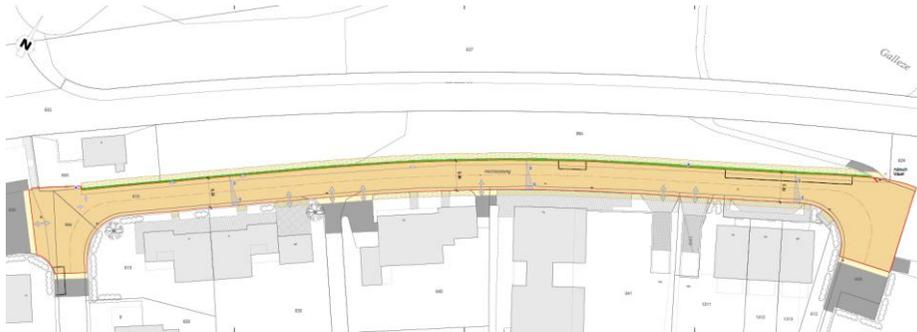
Das Quergefälle der Strasse wird zukünftig mit einem einseitigen Quergefälle von 3% in Richtung Böschung zum Rhein ausgeführt. Damit ändert sich das Quergefälle komplett entgegen dem Ist- Zustand. Mit dem Quergefällewechsel in Richtung Böschung bietet sich neu die Möglichkeit das Strassenabwasser vor Ort über das Bankett zu versickern. Die bestehende Strassenentwässerung entlang des Hochbordweges kann entsprechend aufgehoben werden.
