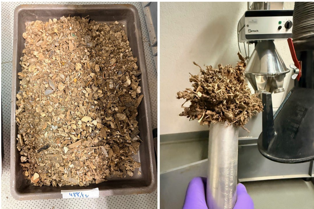
Abb. 8 Aufarbeitung einer Abfallprobe aus einem Entsorgungsbetrieb: Mit einem Magnet werden gröbere Metallteile aussortiert
