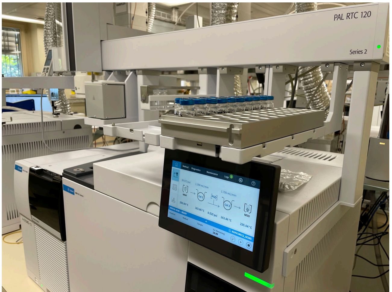
Abb. 9 Messung von Luftproben aus dem Areal Klybeck (BS) auf Lösungsmittel und weitere flüchtige organische Schadstoffe
