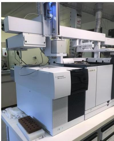
*Bild 9 Messung von organischen Spurenstoffen mittels Gaschromatographie/Massenspektrometrie*
