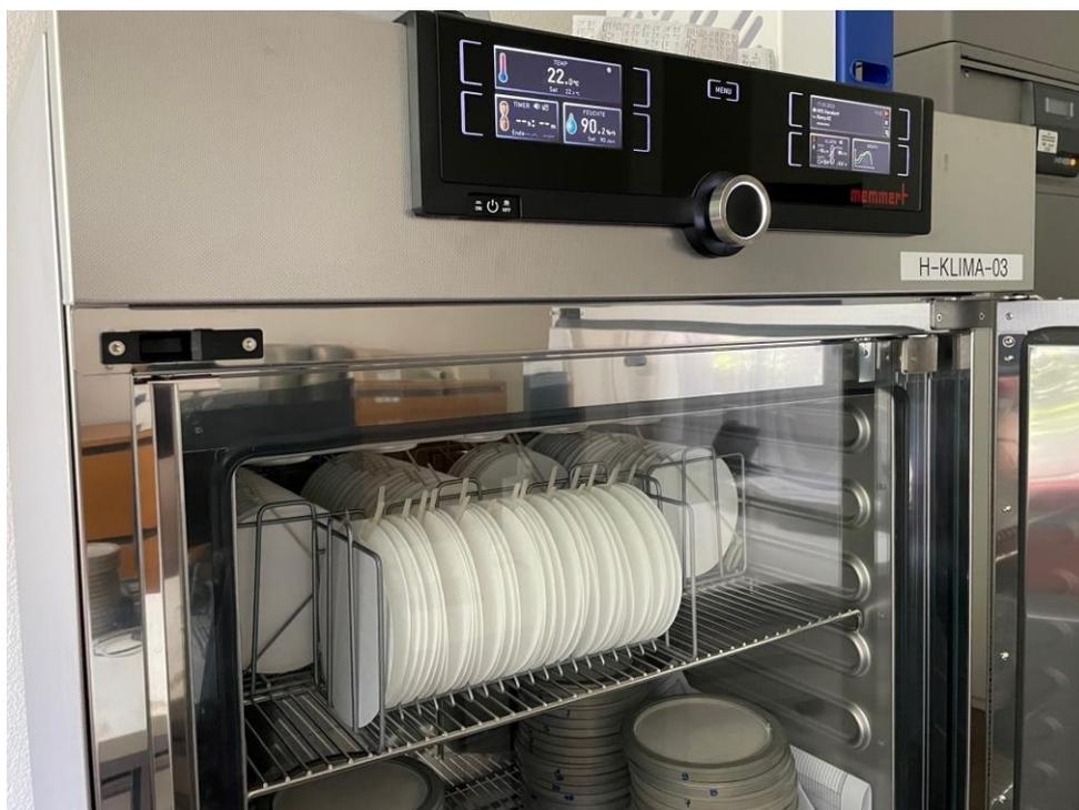
*Bild 11 Filter für die Feinstaubbestimmung werden unter vorgegebenen Klimabedingungen zur Wägung vorbereitet*
