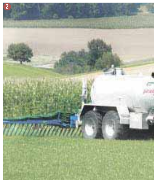
2 Ein Güllefass mit Schleppschlauchverteiler im Einsatz
