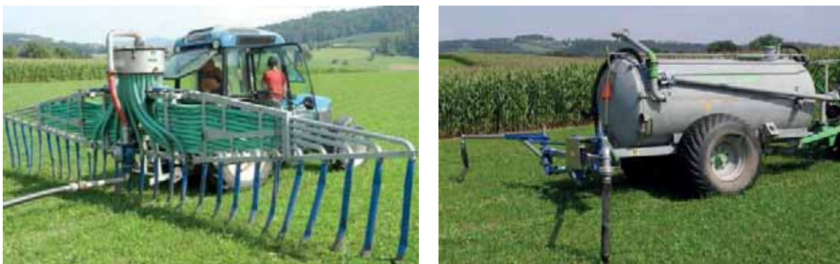
'normaler' Schleppschlauchverteiler und MAI-Schleppschlauchverteiler im Vergleich
