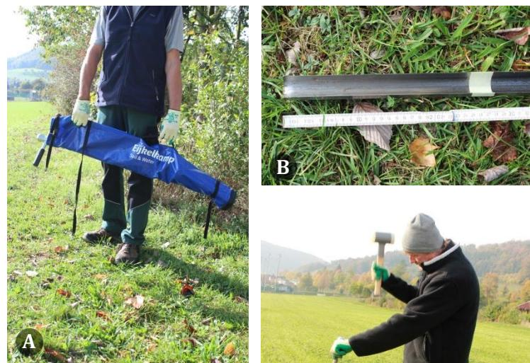
**B)** Mit einem Klebeband die Einstichtiefe auf dem Bohrstock markieren (25 bzw. 30 cm)
