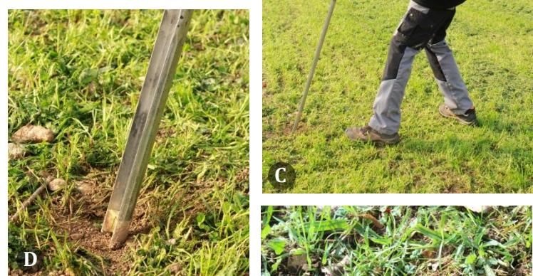
**D)** Bis zur Klebebandmarkierung einschlagen, den Bohrstock einmal ganz runddrehen um die „Bodenkarotte“ auszuschneiden; dann etwas gegen unten an hebend den Bohrstock herausziehen.
