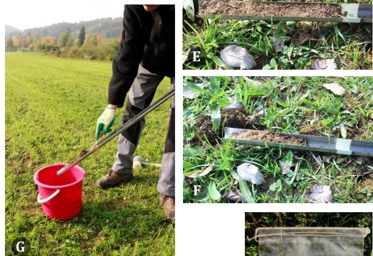
**E)** So sieht ein korrekter Bohrkern aus: ganz ausgefüllt, keine verklemmten Steine, kein Gras.
