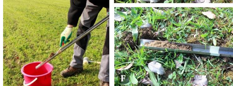
**G)** Mit dem beigelegten Spatel wird das Material im Bohrkern in einen Eimer geschoben.
