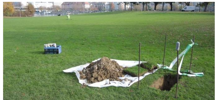
Um Unfallgefahr zu vermeiden, ist je nach Ort wo das Profil steht eine Sicherung durch Zudecken mit Brettern und einer Absperrung ange sagt.
