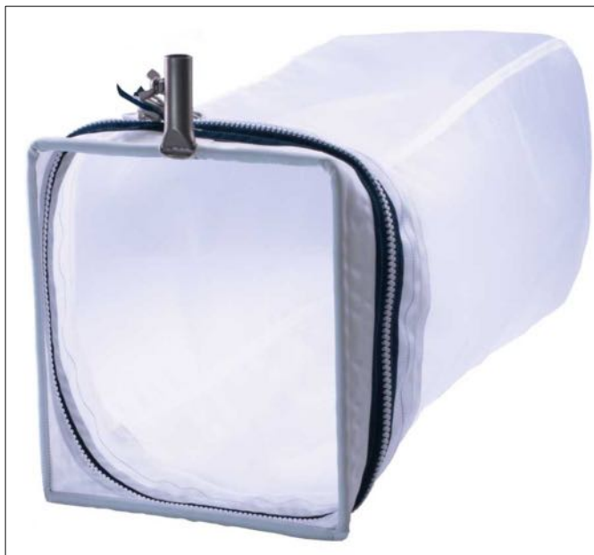
Abb. 4: Kick-Sampling-Netz zur Entnahme flächenbezogener Kleintierproben in Fließgewässern
