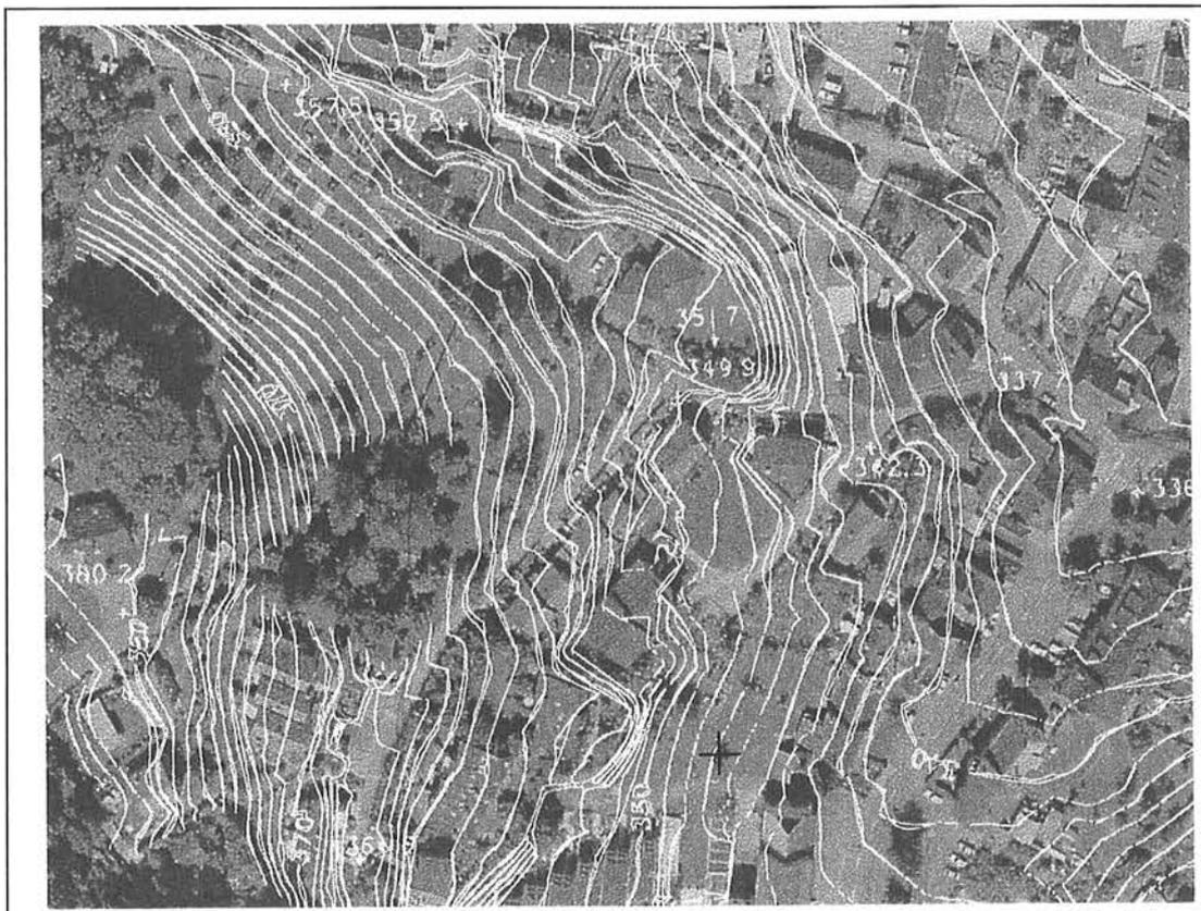
Abbildung 22: Gescannte Orthophoto einer Luftaufnahme mit Höhenkurven Massstab 1:2000,
