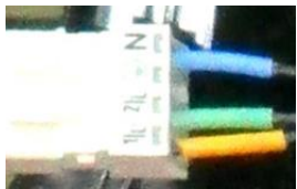
Farbige Schrumpfschläuche auf beiden Seiten der Stecker
