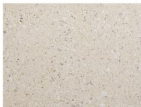
Beton eingefärbt, sandgestrahlt für Mittelinsel + Mauer
