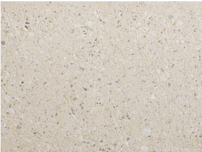
Beton eingefärbt, sandgestrahlt für Mittelinsel + Mauer
