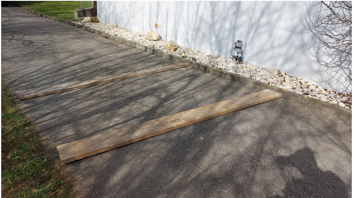
Abb. 1: Fotos des Tests: Durchfahrtstelle mit Gerüstladen und Lastwagen und vertikalem Geofon an der Gebäudewand.
