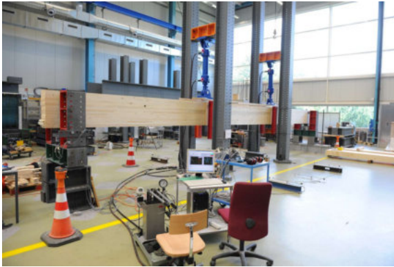
ETH Labortest – vorgespannter Holzrahmen
