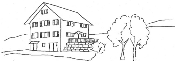
landschaftlich wenig sensible Lösung mit massiver Stützmauer
