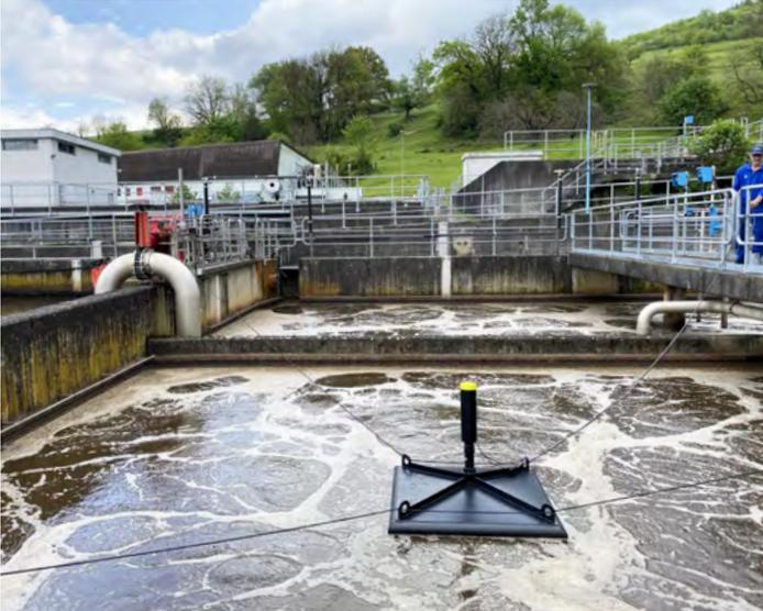
Arbeit mit Messhauben, um die Vorgänge bei der Entstehung des extrem klimaschädlichen Lachgases (N<sub>2</sub>O) besser verstehen und Gegensteuer geben zu können.
