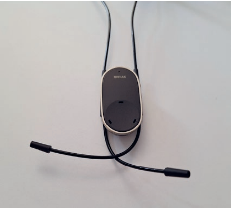
Neckloop- oder Halsschleifen-Mikrofon unterstützt das Hören von einzelnen Sprechenden. (Foto: LKA)
